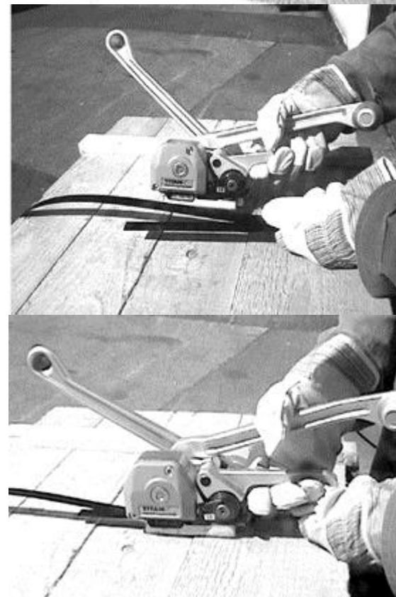
Mit der linken Hand beide Bänder exakt übereinander liegend festhalten. Wippe **509** und Schneidhebel **511** mit der rechten Hand umfassen und zusammendrücken. Beide Bänder bis zum Anschlag an der Gehäusewand seitlich in das Gerät schieben. Dabei muß das untere Band etwas aus dem Gerät herausragen. Die zusammengedrückten Hebel loslassen.
