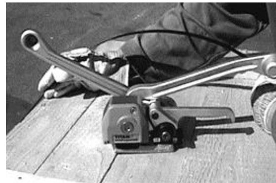
Bandende so weit durchziehen, bis es in der Mitte des Packstückes unter dem Oberband liegt und eine Handlänge hervorragt.
