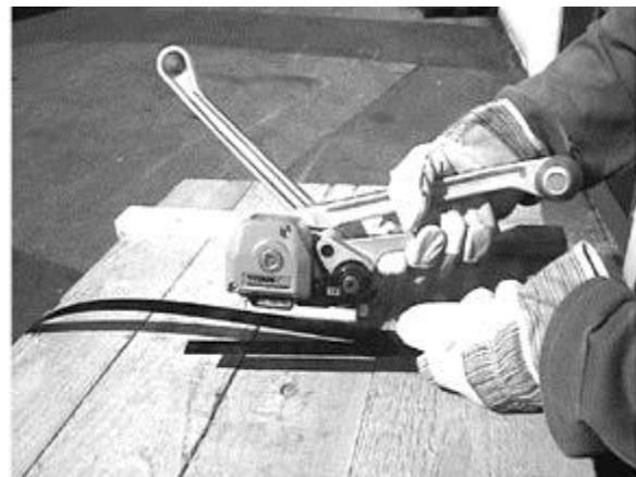
3. Mit der linken Hand beide Bänder exakt übereinanderliegend festhalten. Wippe **509** und Schneidhebel **35** mit der rechten Hand umfassen und zusammendrücken. Beide Bänder bis zum Anschlag an der Gehäusewand seitlich in das Gerät schieben. Dabei muss das untere Band etwas aus dem Gerät herausragen. Die zusammengedrückten Hebel loslassen.
