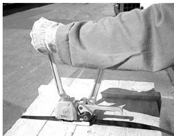
7. Remettre le levier **508** dans sa position de départ. Saisir de la main droite la poignée **509** et le levier **35**. Refermer et serrer. Dégager l'appareil vers la droite.
