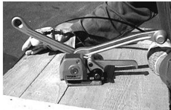
2. Bandende so weit durchziehen, bis es in der Mitte des Packstückes unter dem Oberband liegt und eine Handlänge hervorragt.
