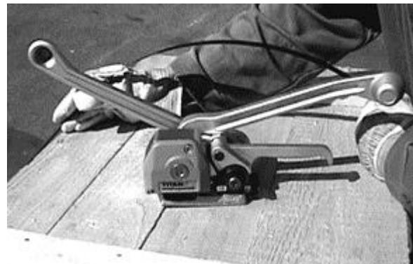
2. Tirer le brin de feuillard jusqu'à ce qu'il se trouve au milieu du colis sous le brin inférieur et dépassant l'appareil d'une longueur de main.
