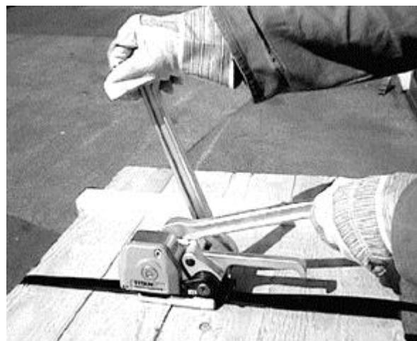
6. La tension désirée obtenue, remettre le levier **508** dans sa position de départ. La main droite y reste et fait ainsi le contre poids durant l'opération de sertissage. La main gauche actionne le levier **35** en avant jusqu'à la butée du carter. Réalisation du sertissage "sans chapes", et simultanément coupe du brin de feuillard venant du dérouleur.
