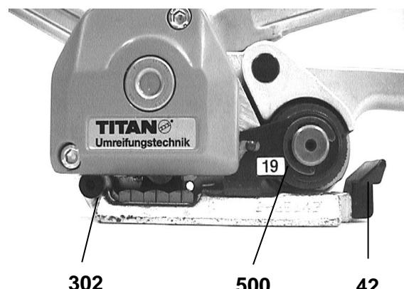
Resserrer les vis de fixation.
