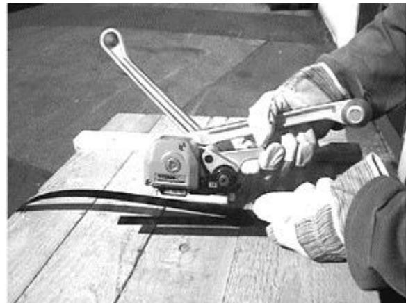
3. Saisir alors les 2 brins de feuillard de la main gauche de façon à ce qu'ils se Recouvrent parfaitement. Saisir de la main droite la poignée **509** et le levier **35**. Refermer la main en serrant. Introduire les deux brins dans l'appareil jusqu'en butée à l'intérieur du carter. Le brin inférieur doit dépasser de quelque peu de l'appareil. Relâcher la pression de la poignée **509** et du levier **35**.
